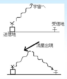
通常使用される周波数は、超短波帯の電波を用いる。従来日本ではFM放送局を利用していた。現在も海外ではこのFM放送局やTV放送局を利用した電波観測が多い。ところが、日本では、FM放送局の増加に伴い、アマチュア無線の電波帯(53.750MHz :福井高専前川氏による)を使用して電波観測を行っている。日本では"HRO(Ham-band Radio Observation)"と呼ばれ、現在は専門の観測者から高校生まで広く用いられている。
